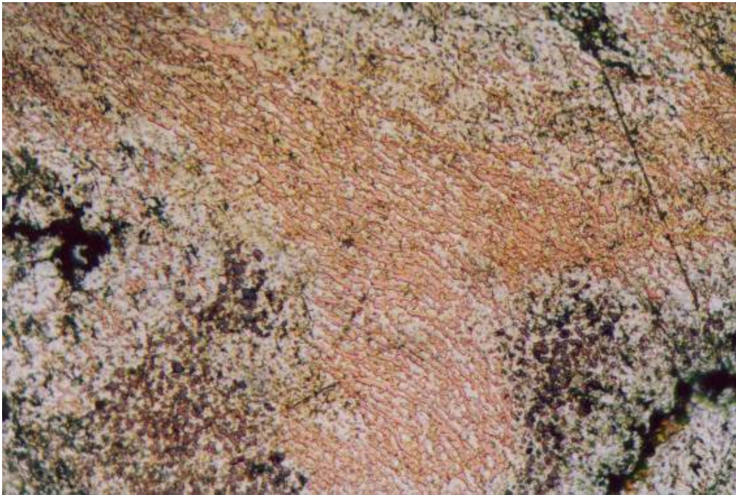
Foto 9. Microscopia óptica: Solución sólida de Ag. Estructura bifásica hipoeutéctica hacia la Ag. Zona clara (Ag), zona rosada (Cu). 200x.
