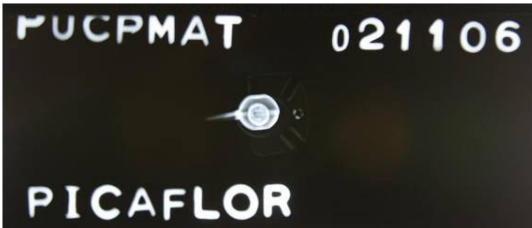
Foto 11. Radiografía: Pieza vista desde la base. Evidencia de tipo de uniones mecánicas y metalúrgicas que tiene la pieza (125 kV x 2 minutos).
